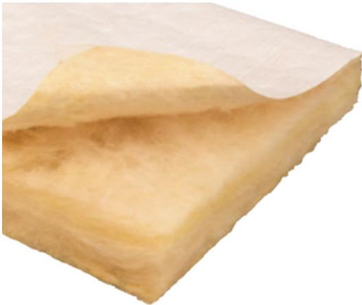
La colchoneta MBI es un rollo flexible de aislamiento térmico, fabricado con fibras de vidrio aglutinadas con resinas termofijas y recubierto con un barrera de vinil satinado o poli propeno reforzado en una de sus caras. Ofrece máxima eficacia acústica y actúa contra la vibración. Ideal para techos y muros de naves industriales y comerciales de gran ligereza y baja conductividad térmica.
