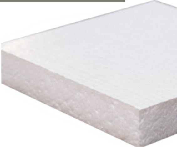
Aislante térmico con base de espuma rígida de poliestireno extruido en presentación de placa con aditivos retardante de flama con aprobación de UL. Tiene una superficie lisa y una estructura de celdas cerradas con paredes que se inter-adhieren entre si, sin dejar huecos. Se fabrica en diferentes resistencias de compresión: 40 lb/in<sup>2</sup> y 60 lb/in<sup>2</sup>.
