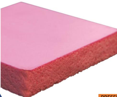
Aislamiento térmico de espuma rígida de poliestireno extruído en paneles manufacturados por el proceso Hidrovac con aditivo retardante de flama. Tiene una superficie lisa y una estructura de celdas cerradas con paredes que se iner- adhieren unas con otras sin dejar huecos. El producto se fabrica en diferentes resistencias a la compresión: 25 lb/in<sup>2</sup>, 40 lb/in<sup>2</sup>, 60 lb/in<sup>2</sup>, 100 lb/in<sup>2</sup>.
